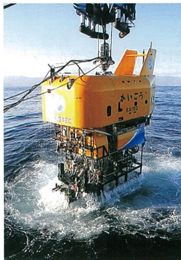
海底資源探査などを目的にビークル部分を新たに開発した無人探査機「かいこうMK-IV」
