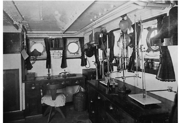
図4. 鵜丸の観測室。塩検・溶存酸素滴定用のビュレットやプランクトン観察用の顕微鏡が見える。5,000 mと1,000 mの電動ウインチを装備し，船尾には調査員8名分のベッドがあった（朝鮮総督府水産試験場（1933）より複写）。
