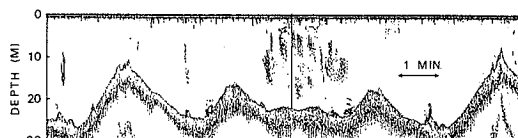
図 8 給餌ロボットを中心とした半径50mのうずまき型航走記録
