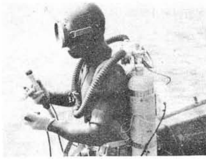
第2図 試作したアクアラング用水中電信電話装置を潜水者に取り付けた状況。
